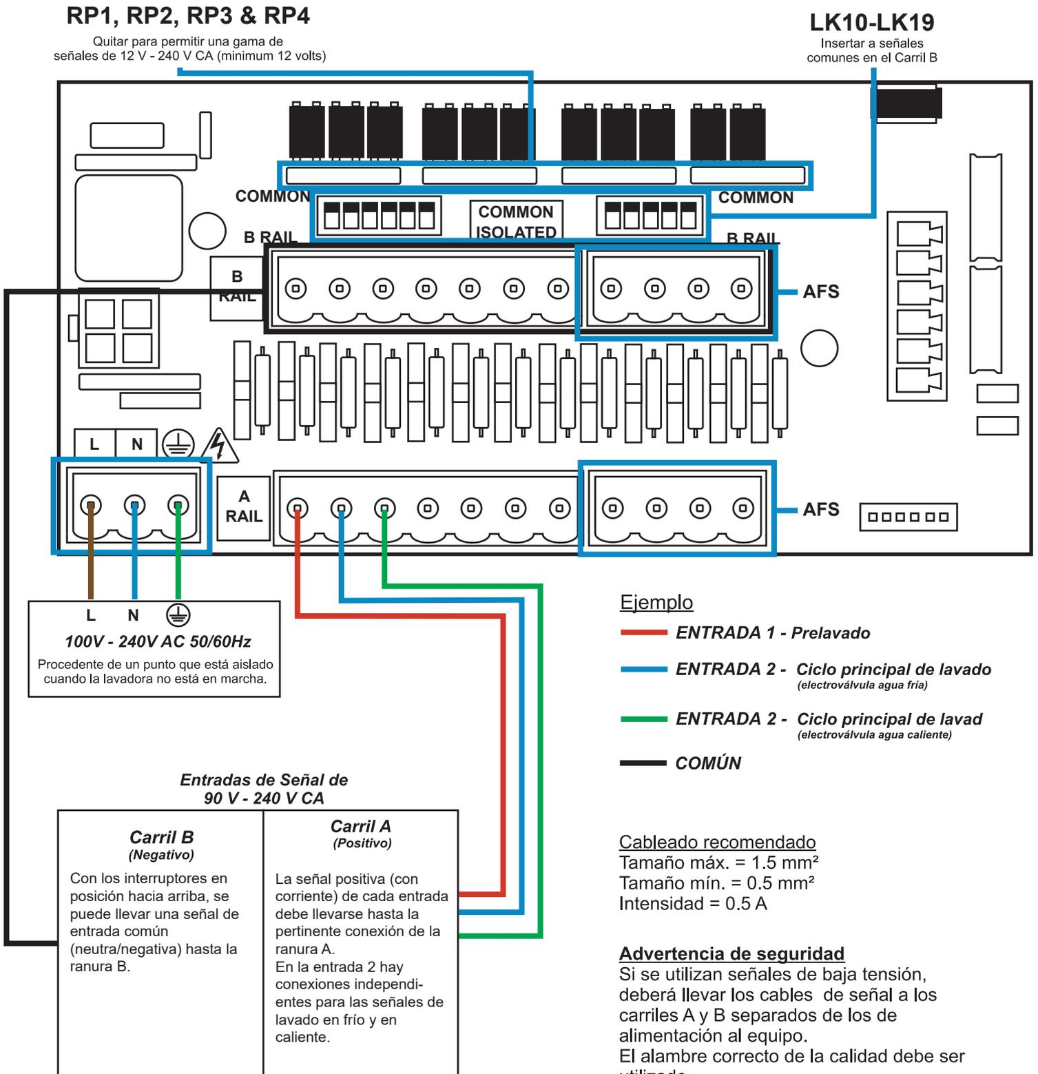
En algunos casos, la tarjeta interfaz ó las electroválvulas en la lavadora no tienen un único común. Por ejemplo: La electroválvula del suavizante en algunas máquinas Miele no está unida mediante un cable común a las otras electroválvulas.
