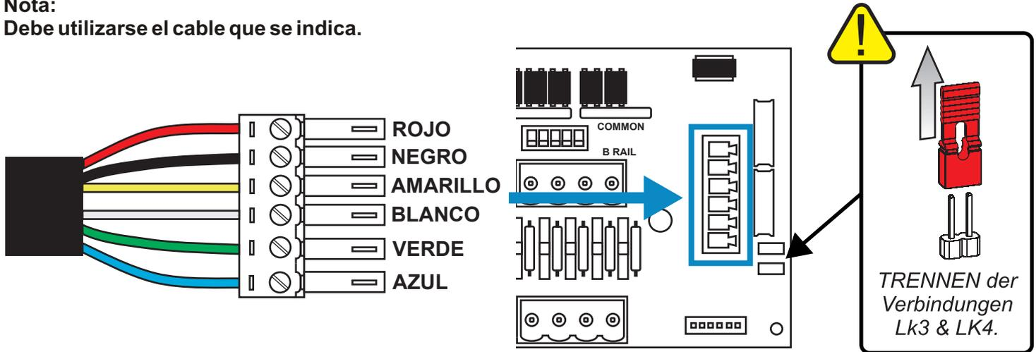
Instalar el conector verde con los cables de color conforme al orden que recoge la ilustración. Enchufar el conector al enchufe hembra correspondiente y ajustar el prensaestopas en torno al cable.
